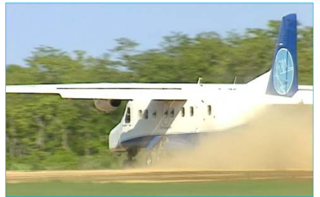
転圧滑走路に着陸する実験用航空機（JAXA）
