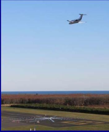
平成23年11月7日から30日までJAXA航空プログラムグループにより「ジェット機飛行音源探査計測技術研究開発」のための飛行試験が大樹町多目的航空公園で行われました。この実験は、2009年から行われており、今年で3回目の実験となります。多目的航空公園の滑走路上の直径50mの範囲に198本のマイクロフォンを設置し、その上空を小型ビジネスジェット機 (MU-300)が低空飛行で繰り返し通過し、音源データなどを収集します。1フライト平均18回の周回飛行を繰り返し、最低高度60mの低空で滑走路を飛行しました。JAXA実験担当者は、「騒音が出る実験であるのに、毎年、快く受け入れていただいている住民の方々や
