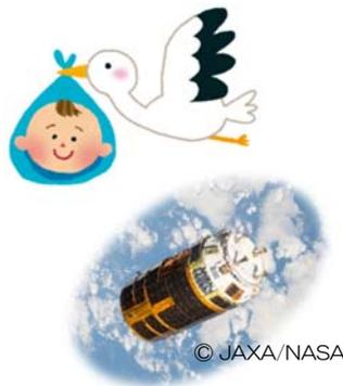
現在、ISSへの補給船はHTVの他にアメリカ、ロシア、欧州にあり、それぞれ特徴や目的が違っています。HTVは、1.3 m四方のハッチを備えており、大型の実験資材をISSへ輸送できる唯一の補給船である他、6号機現在まで一度も失敗しておらず、安定した輸送が特徴です。
