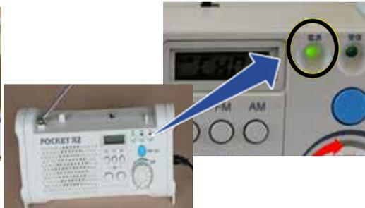
電池を入れておくと、停電の際に自動で電池の電源に切り替わります。電池残量が少なくなると電源ランプが「赤」と「緑」に交互に点滅します。1年に1回は電池を交換しましょう。
