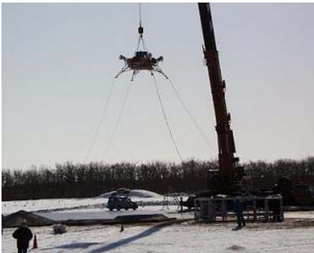
2001.2.19 月面軟着陸実験機フライング・テスト・ベッ デザー試験
