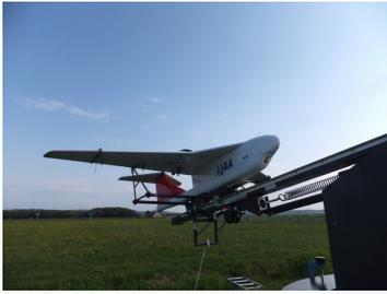
JAXA無人機・未来型航空機チームでは、5月21日から6月1日まで、大樹町多目的航空公園滑走路とJAXA大樹航空宇宙実験場で、「小型無人機飛行実験」を実施しました。今年で3年目となるこの実験は、河川等の災害時に重要とされている「初動監視」（自動操縦で災害場所等の空撮など）を実現するために、短距離発進などの機動性や自動飛行などの簡易操作性や安全性を高めるために行われました。今年秋の実験では、歴舟川上流で災害を想定した飛行実験を実施する予定です。
