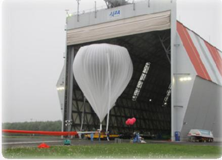
平成24年6月3日（日）午前4時55分に、平成24年度第一次気球実験の1号機がJAXA大樹航空宇宙実験場から放球されました。この実験は、宇宙線反粒子検出器「GAPS（ギャップス）」のプロトタイプ（本格観測用の観測装置をシンプルにしたもの）性能評価を目的とした実験でした。また、この実験に使用された気球は、上空で、満膨張体積100,000m<sup>3</sup>、直径63mになる大型気球でした。午前9時頃に、高度31.2kmに達し、上空で観測実験を行った後、海上に緩降下し、地元漁業者の方々の協力によって、回収されました。
