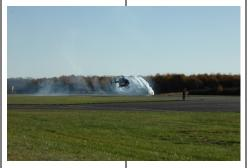
航空公園において「ヘリコプタの後流計測」が行われました。この実験は、ヘリコプタの後流(後方にまわりこむようにできる流れ)により後続機や駐機中の機体(特に小型機)の姿勢が乱れ、飛行安全に影響を及ぼす事があるため、飛行安全向上に向け、ヘリコプタ後流の空間的広がりや挙動を計測する事を目的に実施されました。実験では、ヘリコプタを主に滑走路上で飛行させ、その後流をドップラーライダ(レーザレーダ)や超音波風速計で計測したり、煙を使って可視化を行いました。
