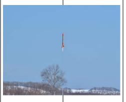
ハイブリッドロケット36号機 (H-36) は、3/12に打上げられ、エンジンの酸化剤供給システムの刷新を図り、より安全で大型化を可能とするための基礎実験を行いました。
